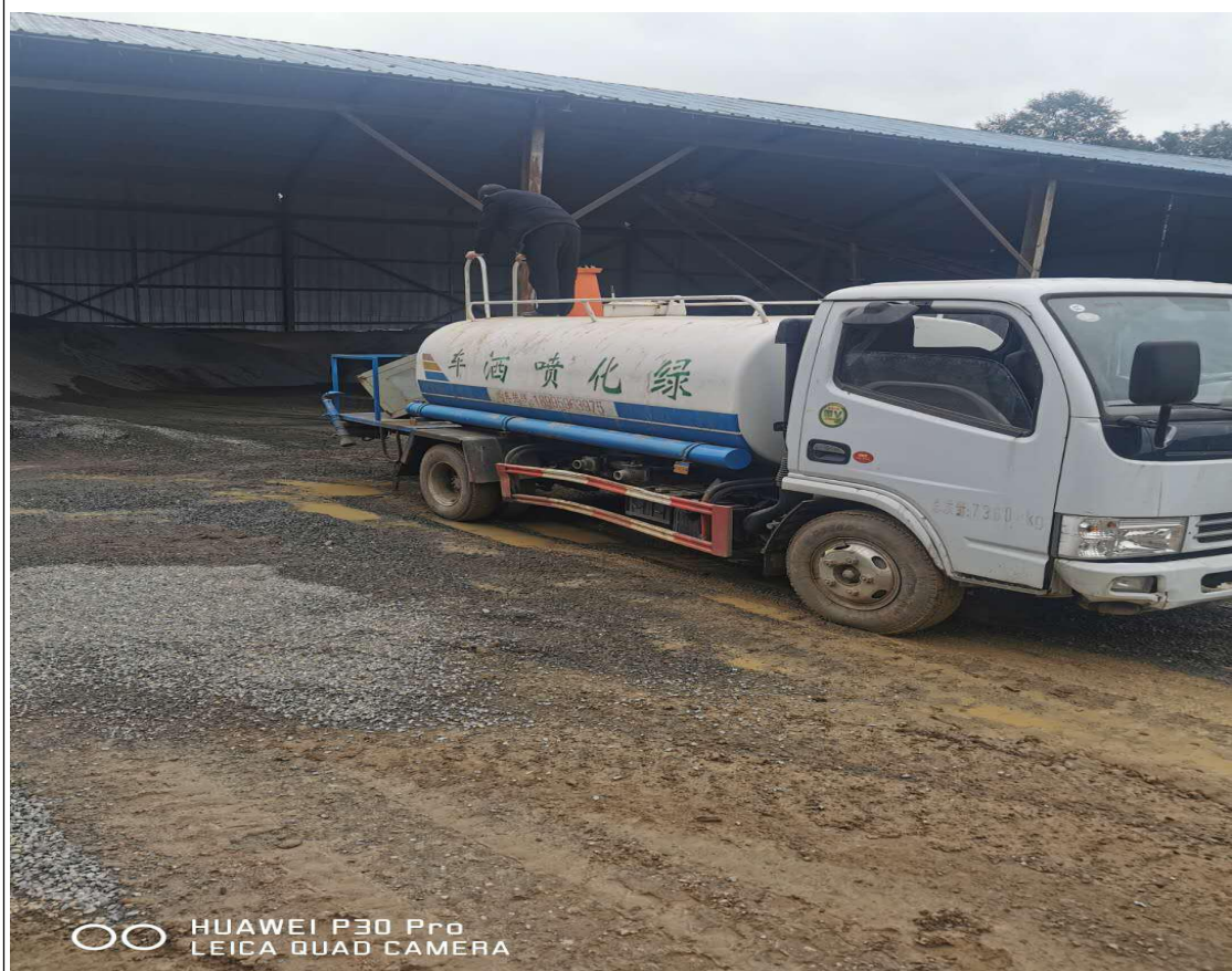
图 5-2 项目区现场水炮喷雾除尘设备
