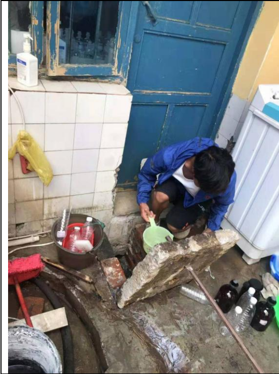
污水处理系统进口监测取样图
